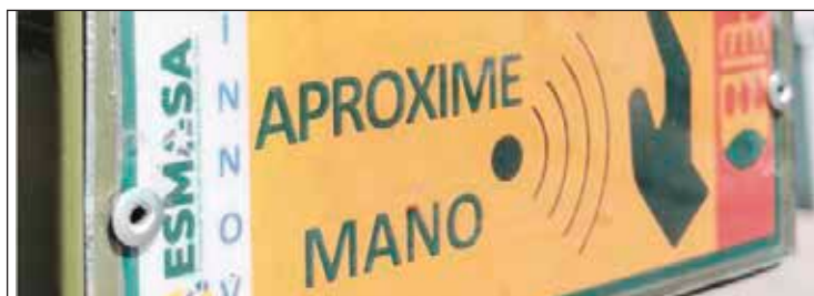
Hay que acercar la mano y el semáforo emite una señal de activación
