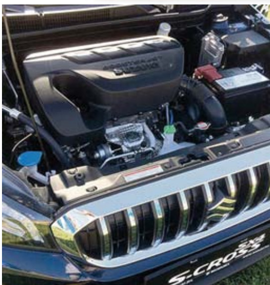
La mecánica básica es el 1.0 BoosterJet, motor de tres cilindros con turbo compresor e inyección directa.
