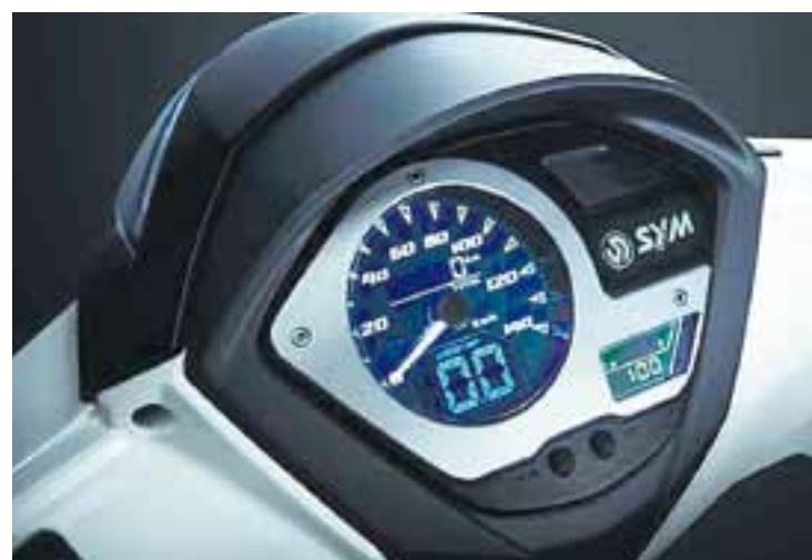
Su instrumentación analógica y digital "Dual LCD", permite convertir la esfera del velocímetro en cuentarrevoluciones y viceversa
